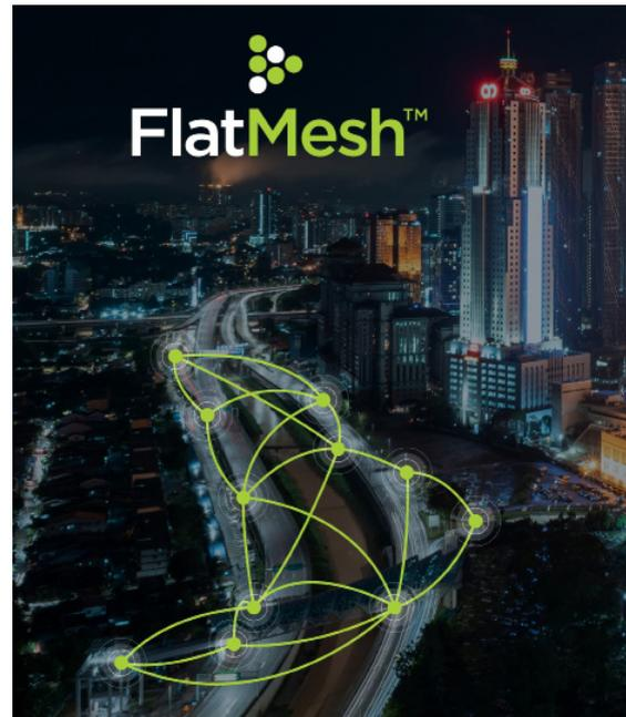
Innerhalb des dynamischen, nicht-hierarchischen FlatMesh™ kommunizieren benachbarte Nodes untereinander und reichen die Datenpakete auf dem kürzesten verfügbaren Weg zum 3G-/4G-Gateway weiter. Systemintern wird die Datenübergabe permanent optimiert, so dass Ausfälle einzelner Links automatisch umgangen werden.
